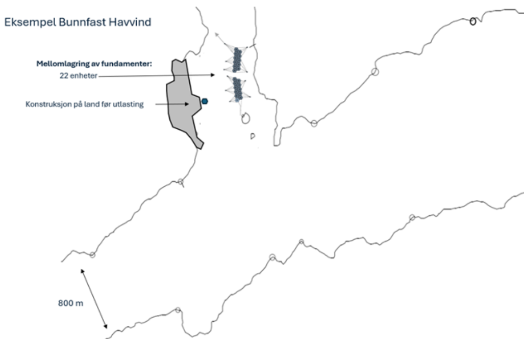
Figur 5-9. Eksempel på mellomlagring av GBS fundament i Vatsfjorden.
