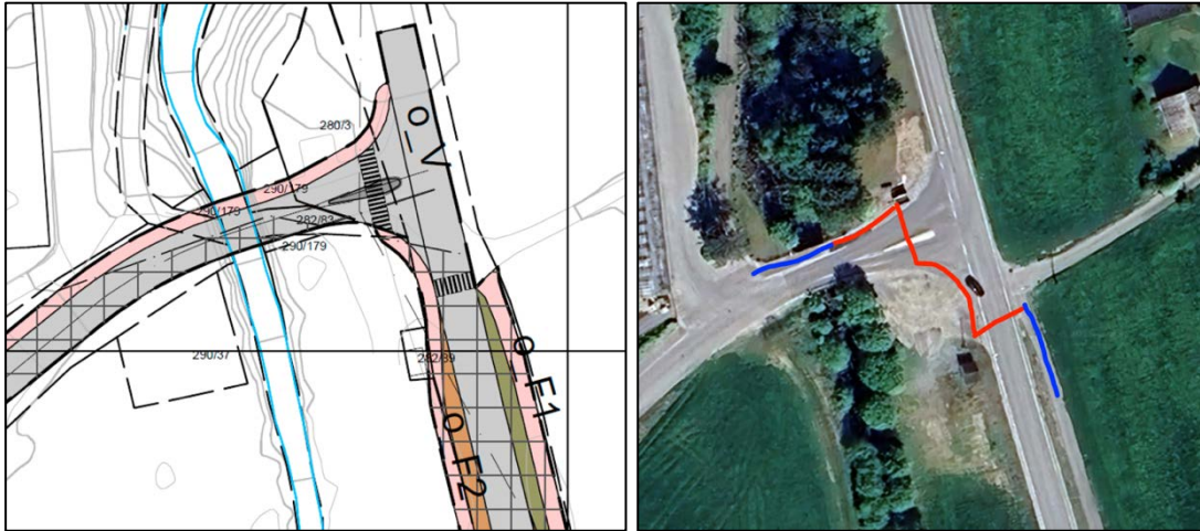
Figur 30: Regulert kryss tv. og th. visa kva som er opparbeidd (blått) og kva som mangla (raudt), kjelde: Asplan Viak og google earth, rev Arkipelet
