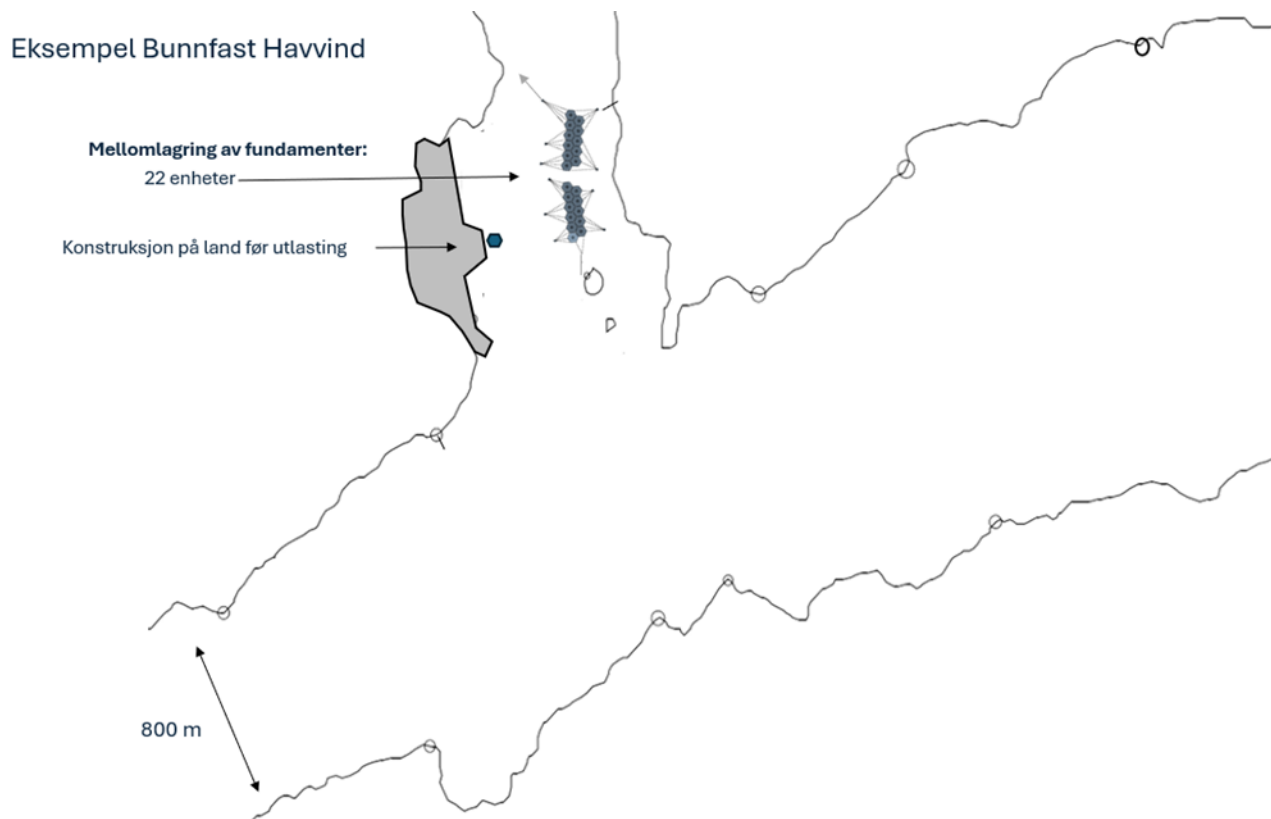
Figur 1-18. Eksempel på mellomlagring av GBS-fundamenter i Vatsfjorden
