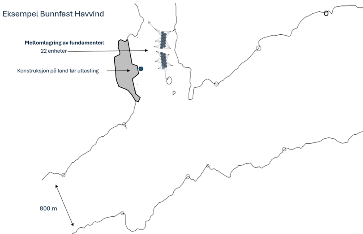
Figur 1-18. Eksempel på mellomlagring av GBS-fundamenter i Vatsfjorden
