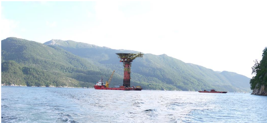
Figur 2-10. T.v. oppankring av flytende vindturbin i Vatsfjorden 2024. T.h. oppankring av SPAR-bøye med 134 m dypgang i Yrkefjorden
