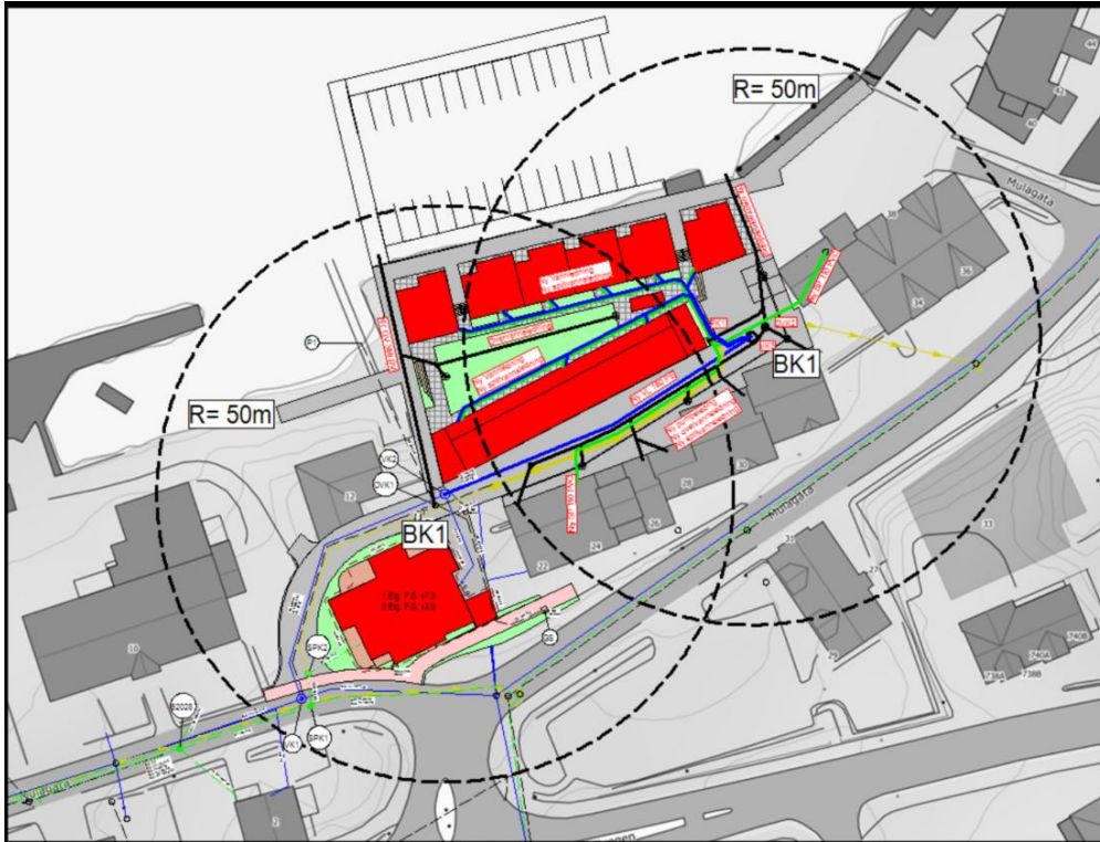
Figur 11: Skisse brannkum, kjelde RH Oppmåling
