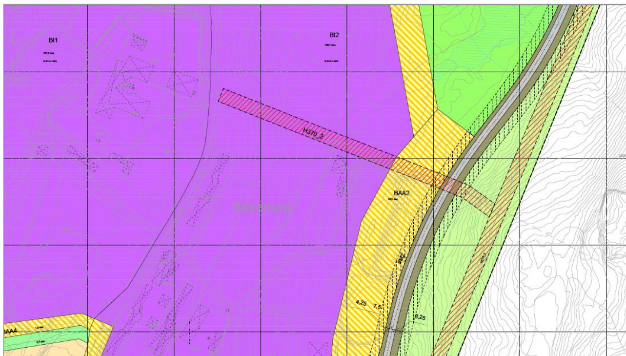
Figur 55 Viser kombinert byggje- og anleggsområde BAA2 der breidda på skjeringa kan bli opp mot ca. 60 m og 55 meter høg, men utan føresegsområde, jf. plankart datert 17.02.2026.
