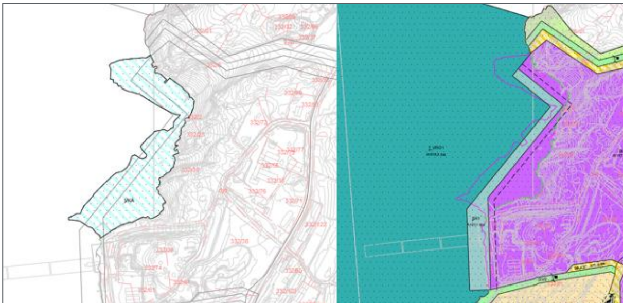
Figur 57 Venstre del av figur viser område som blir fylt ut på sjøbotnen (inkl. fyllingsfot). Arealet på sjøbotn er 37.8 daa. Til høgre illustrert samen med plankart som viser topp fylling industriområde og ny kaifront (lyseblått)
