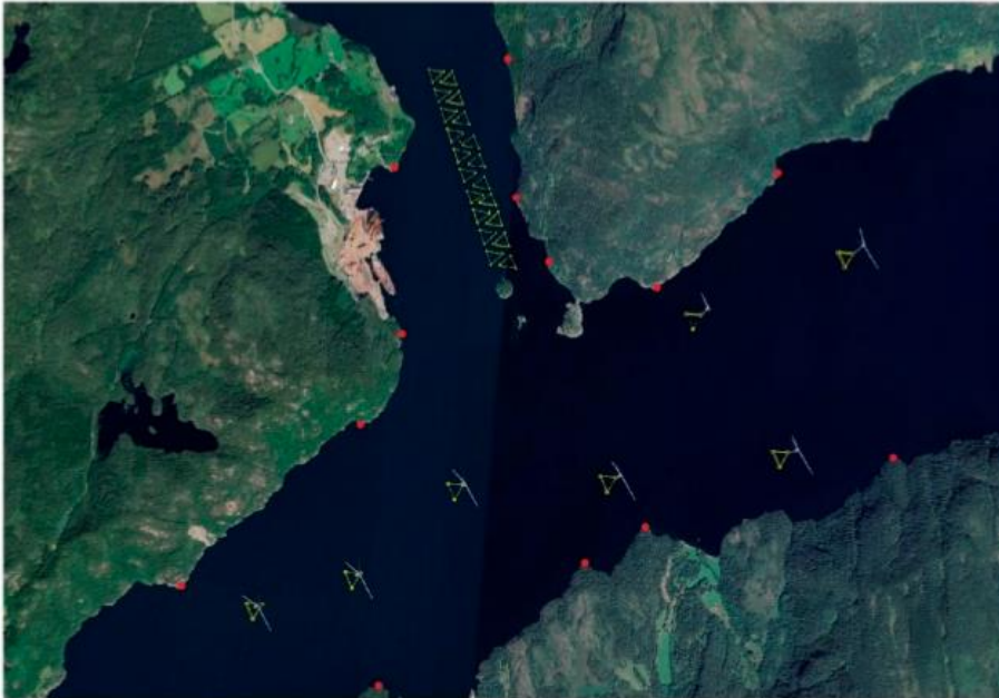
Illustrasjon av prinsipp for lagring av ferdigmonterte vindturbinar i Yrkefjorden og flytande fundament i Vatsfjorden. Eksisterande ankringspunkt er markert med raudt.
