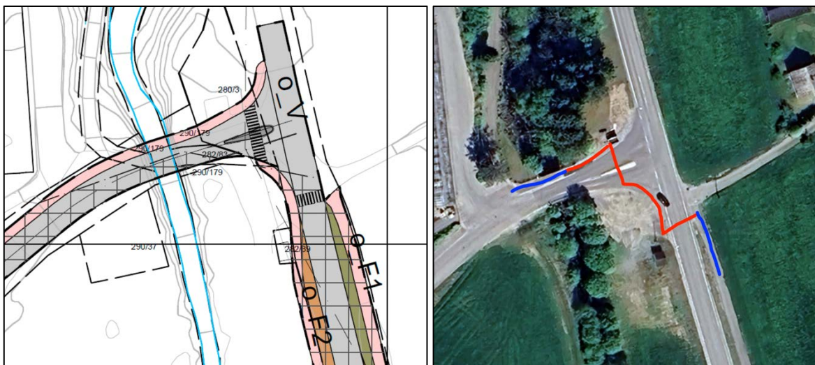
Figur 49: Regulert kryss tv. og th. visa kva som er opparbeidd (blått) og kva som mangla (raudt), kjelde: Asplan Viak og google earth, rev Arkipelet
