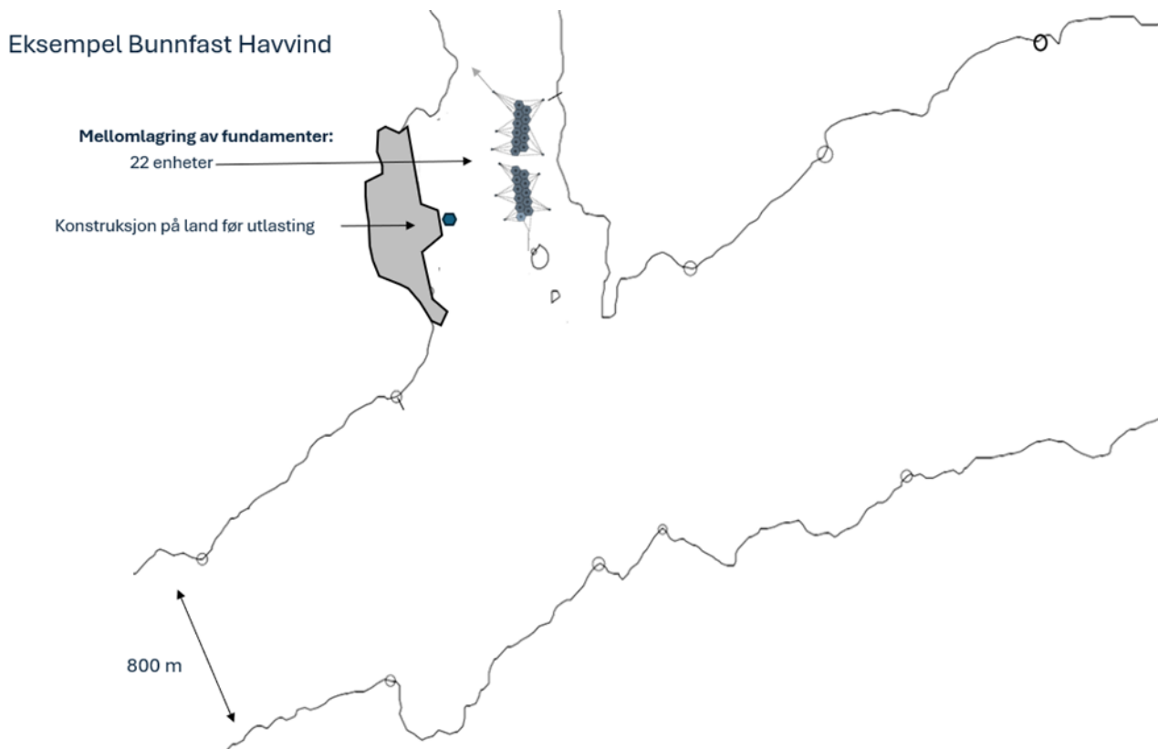
Figur 1-18. Eksempel på mellomlagring av GBS-fundamenter i Vatsfjorden
