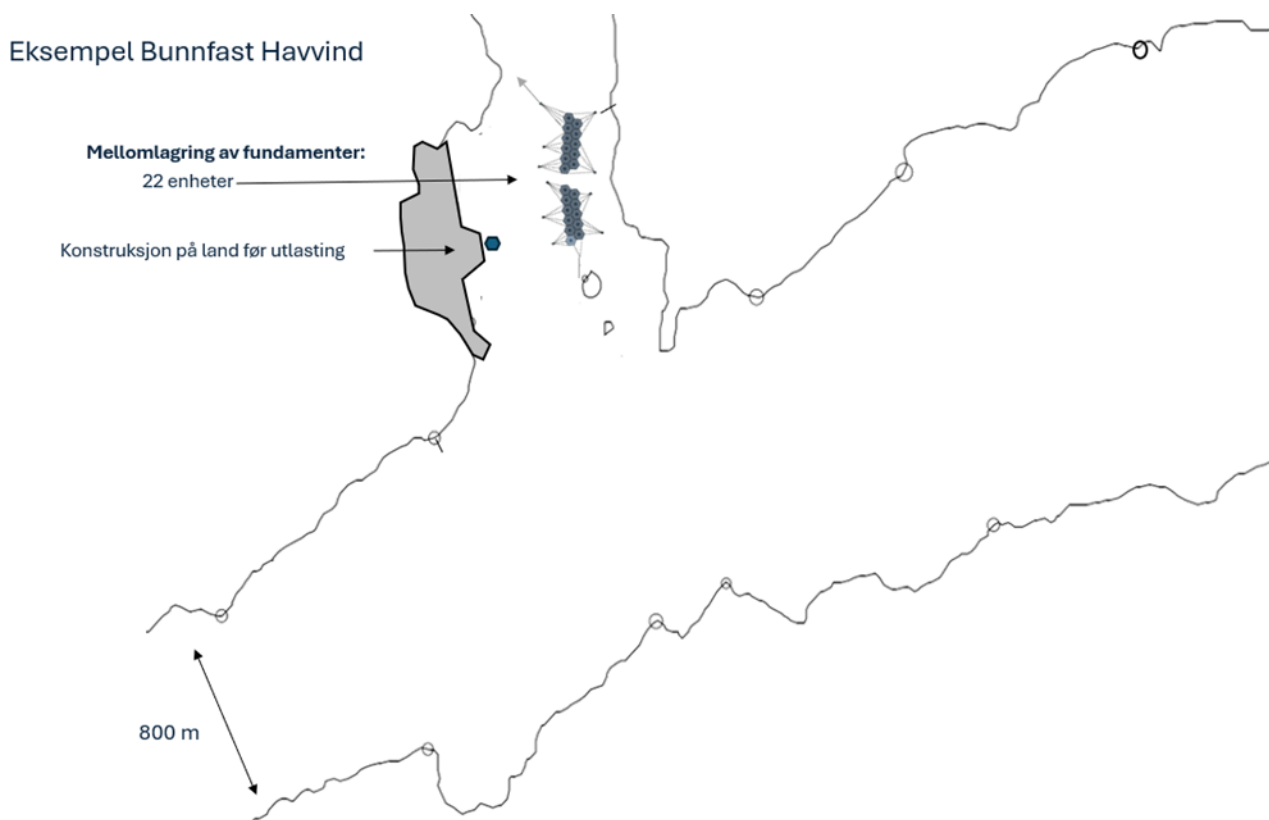
Figur 4 Eksempel på våtlagring av klynger med GBS-fundamenter i Vatsfjorden
