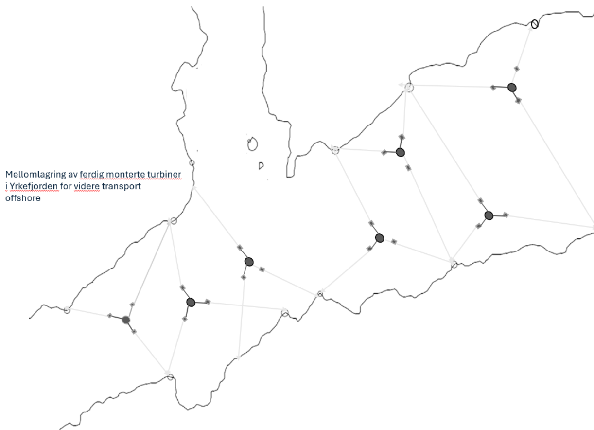
Figur 6 Mulige mellomlagringsplasser i Yrkefjorden for ferdig monterte vindturbiner
