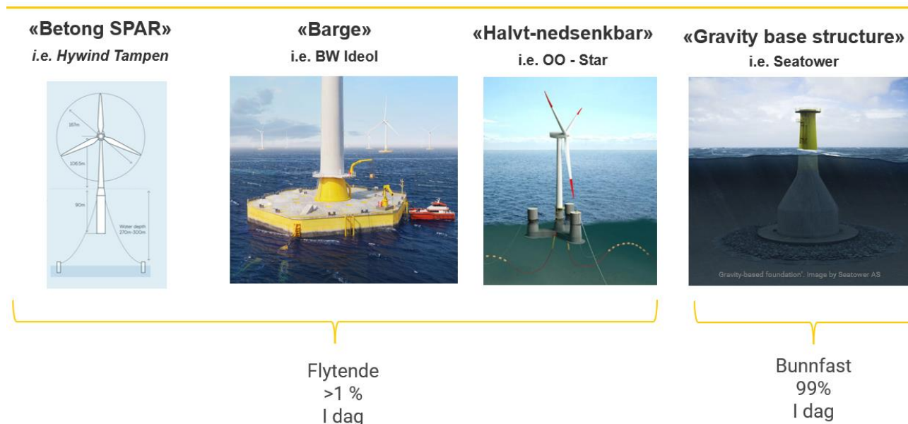
Figur 2-1. Fundamenttyper for havvind som er aktuelle for produksjon i Vats
