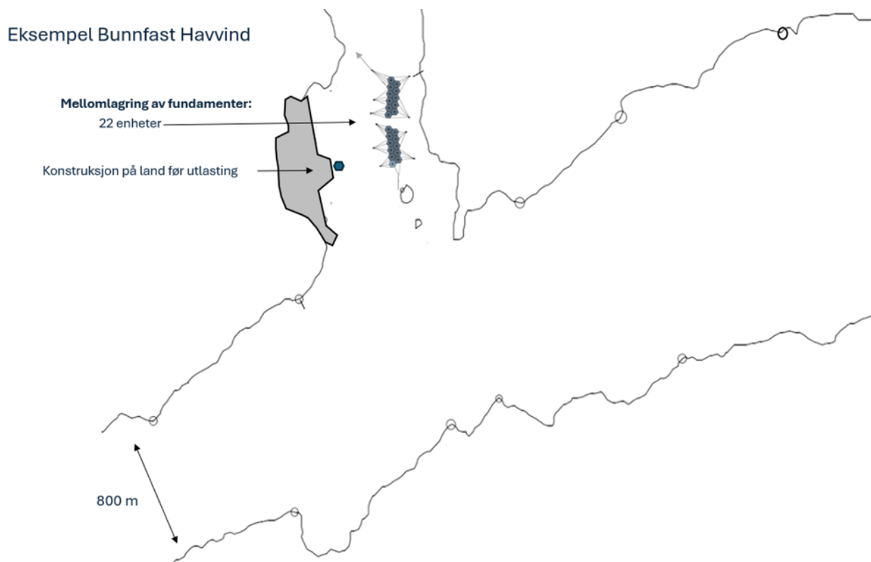
Figur 2-18. Eksempel på mellomlagring av GBS-fundamenter i Vatsfjorden
