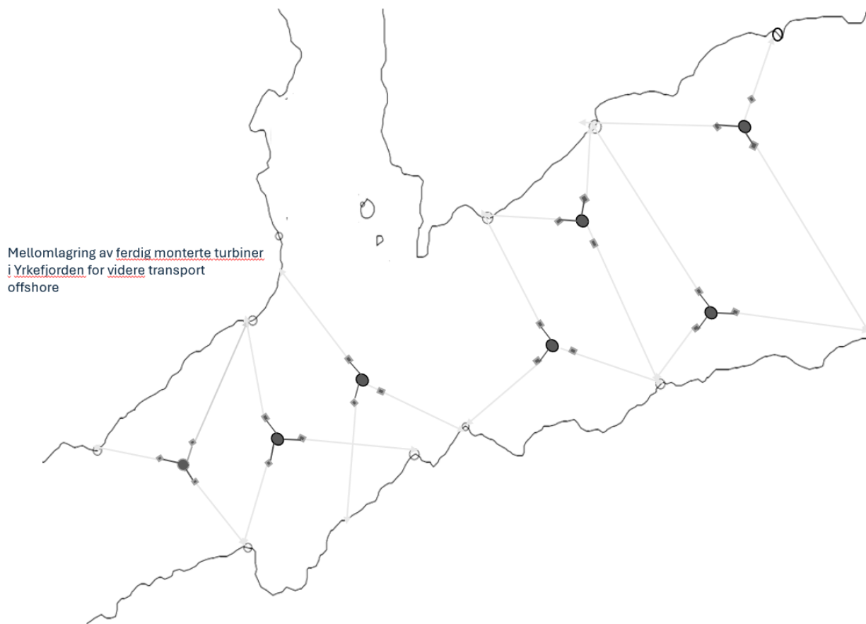
Figur 1-11. Mulige mellomlagringsplasser i Yrkefjorden for ferdig monterte vindturbiner. Maksimalt 7 turbiner vil kunne lagres i fjorden samtidig. Denne løsningen er lagt til grunn i synlighetskartet.
